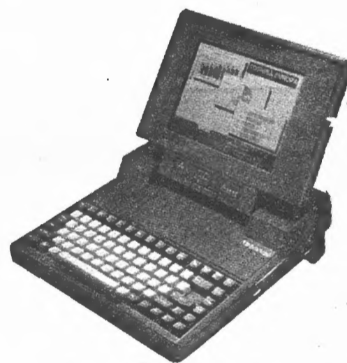
T 3100 Processador 80286, 8 MHz, 640 kb RAM 1 Disco Fixo 20 Mb, 1 Floppy 3,5" 720 kb Display Plasma de Alta Resolução, Peso 6.8 kg.
